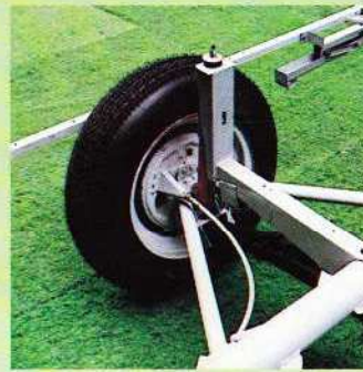
Detailaufnahme der Reserveradaufhängung mit Stossdämpfer und Bremsstrommel.
