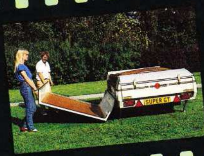
Der einfache Aufbau vom Super GT und GT-Export. Den festen Deckel nach der Seite umlegen.
