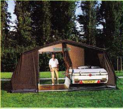
Hochrollbare Eingangstür im Wagenzelt an der Deichselseite; zusätzliche Tür und noch mehr Entlüftungsmöglichkeit.
