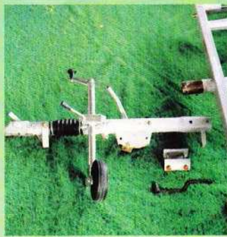
Abnehmbare Zugdeichsel für problemlose Lagerung in der Garage.
