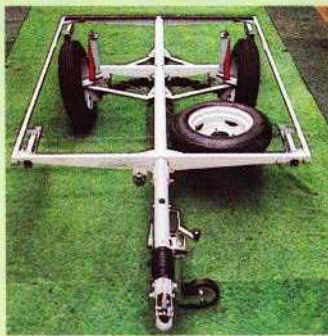
Unter das Fahrgestell (gut für 500 kg Tragfähigkeit) kann zusätzlich ein Reserverad mit Halterung montiert werden.
