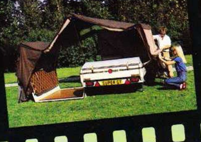
Die rechte Klappe nach aussen scharnieren. Nirgendwo sind lose Zeltstangen anzubringen...
