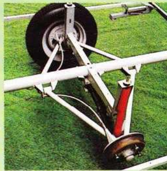
Die unabhängige Federung mit Stabilisatorstangen und Stossdämpfern.
