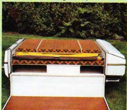
Für die zusätzlich lieferbaren Matratzen ist zusätzlicher Transportraum unter dem Deckel eingebaut. Beim Ausfalten liegen sie dadurch schon fix und fertig da.
