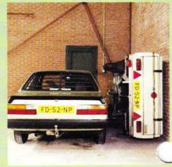
Auf der zusätzlich lieferbaren, fahrbaren Kippvorrichtung ist er einfach neben oder vor den PKW in der Garage zu lagern.
